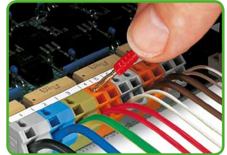
Prüfen mit Prüfstecker Ø 2 mm.
