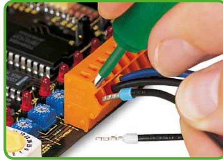
Leiter anschließen/lösen - Leiter mit Aderendhülse.
