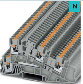
4 (4) mm², 30 A, Dreistockklemme, 1 x Außenleiter L, 1 x Trennzone
