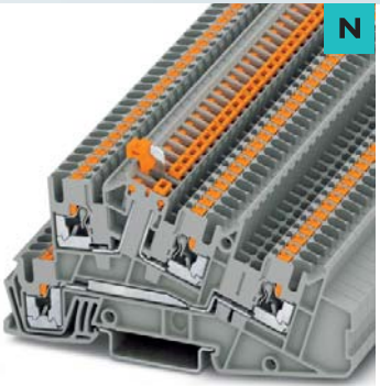
4 (4) mm², 30 A, Dreistockklemme, 1 x Außenleiter L, 1 x Außenleiter L trennbar
