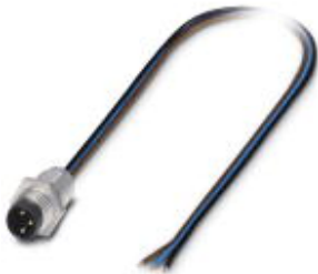
Sensor-/Aktor-Einbaustecker, 3-polig, M8, Vorderwand-/Schraubmontage mit M8 Gewinde, mit 0,5 m TPE-Litze, 3 x 0,25mm 2
