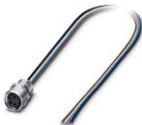
Sensor-/Aktor-Einbaubuchse, 4-polig, M8, Vorderwand-/Schraubmontage mit M8 Gewinde, mit 0,5 m TPE-Litze, 4 x 0,25mm 2
