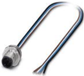
Sensor-/Aktor-Einbaustecker, 4-polig, M12-SPEEDCON, A-kodiert, Vorderwand-/Schraubmontage mit M16-Gewinde, mit 0,5 m TPE-Litze, 4 x 0,34 mm 2
