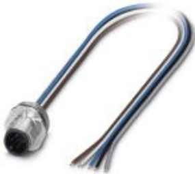
Sensor-/Aktor-Einbaustecker, 5-polig, M12-SPEEDCON, A-kodiert, Vorderwand-/Schraubmontage mit M16-Gewinde, mit 0,5 m TPE-Litze, 5 x 0,34 mm 2
