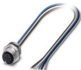
Sensor-/Aktor-Einbaubuchse, 5-polig, M12-SPEEDCON, A-kodiert, Vorderwand-/Schraubmontage mit M16-Gewinde, mit 0,5 m TPE-Litze, 5 x 0,34 mm 2
