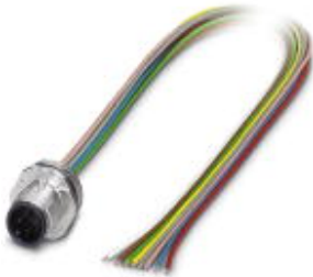
Sensor-/Aktor-Einbaustecker, 8-polig, M12-SPEEDCON, A-kodiert, Vorderwand-/Schraubmontage mit M16-Gewinde, mit 0,5 m TPE-Litze, 8 x 0,25 mm 2
