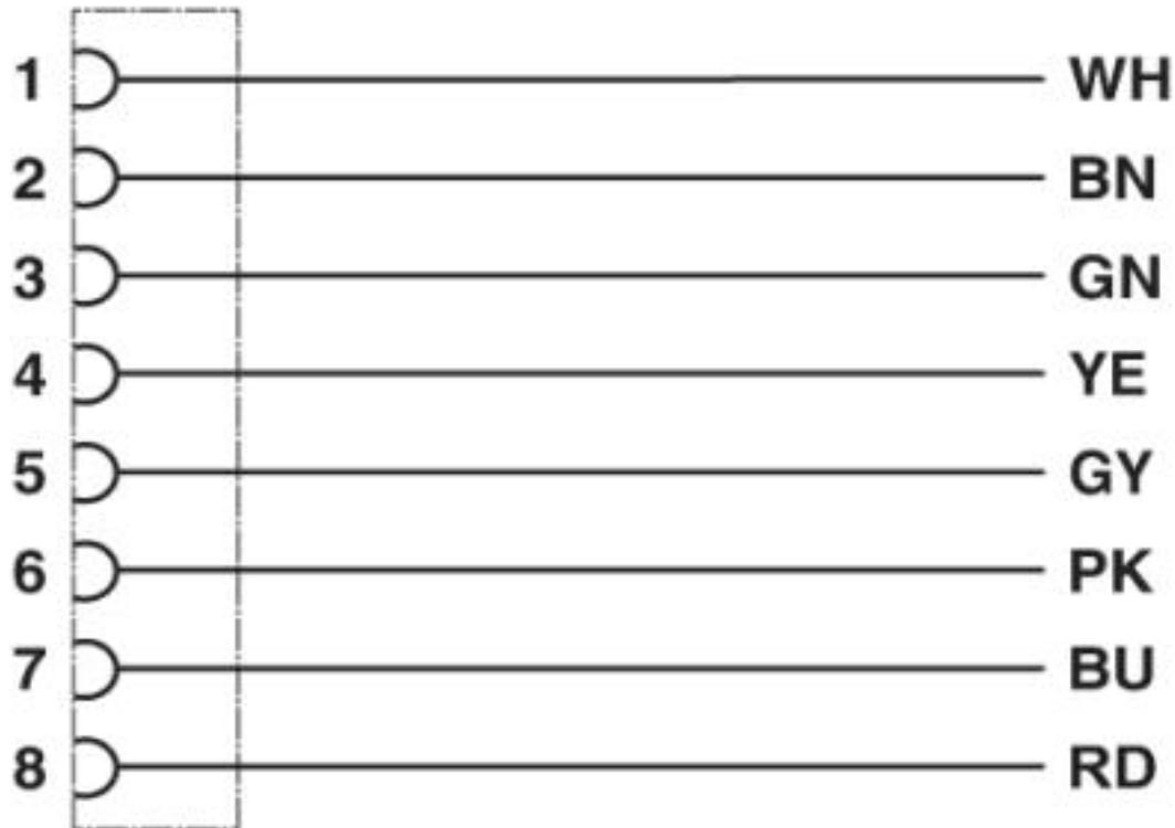
Kontaktbelegung der M12-Buchse
