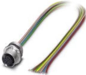
Sensor-/Aktor-Einbaubuchse, 8-polig, M12-SPEEDCON, A-kodiert, Vorderwand-/Schraubmontage mit M16-Gewinde, mit 0,5 m TPE-Litze, 8 x 0,25 mm<sup>2</sup>
