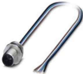
Sensor-/Aktor-Einbaustecker, 4-polig, M12, A-kodiert, Vorderwand-/Schraubmontage mit Pg9 Gewinde, mit 0,5 m TPE-Litze, 4 x 0,34 mm 2
