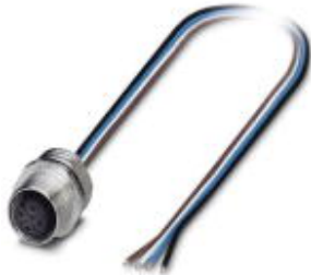
Sensor-/Aktor-Einbaubuchse, 4-polig, M12, A-kodiert, Vorderwand-/Schraubmontage mit Pg9 Gewinde, mit 0,5 m TPE-Litze, 4 x 0,34 mm 2
