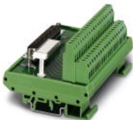
VARIOFACE-Modul, mit Schraubanschluss und D-Subminiatur-Buchsenleiste, zur Montage auf NS 35/7,5 oder NS 32, Polzahl 25
