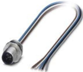
Sensor-/Aktor-Einbaustecker, 5-polig, M12, A-kodiert, Vorderwand-/Schraubmontage mit Pg9 Gewinde, mit 0,5 m TPE-Litze, 5 x 0,34 mm<sup>2</sup>
