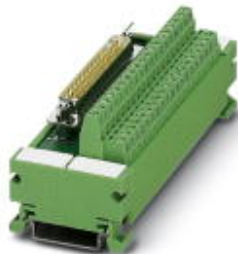
VARIOFACE-Modul, mit Schraubanschluss und D-Subminiatur-Stiftleiste, zur Montage auf NS 35/7,5, Polzahl 37
