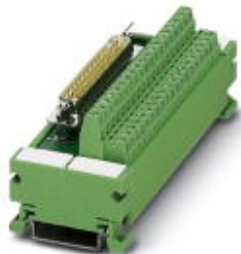
VARIOFACE-Modul, mit Schraubanschluss und D-Subminiatur-Buchsenleiste, zur Montage auf NS 35/7,5, Polzahl 25
