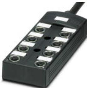
Sensor-/Aktor-Box, Anschlussart: M12-Buchse Metall, Anzahl der Steckplätze: 8, Polzahl: 5, Steckplatzbelegung: doppelt, Statusanzeige: Nein, Universal; Stammleitungsanschluss: Festanschluss 180°, PUR/PVC, Leitungslänge: 5 m, Schirmung: nein
