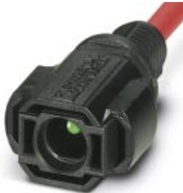
Photovoltaik-Steckverbinder, Nennstrom: 27 A, Nennspannung: 1500 V, Anschlussart: Crimp, Farbe: schwarz, Nur mit Werkzeug entriegelbar
