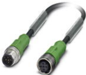
Sensor-/Aktor-Kabel, 5-polig, PUR halogenfrei, schwarzgrau RAL 7021, Stecker gerade M12, A-kodiert, auf Buchse gerade M12, A-kodiert, Kabellänge: 3 m
