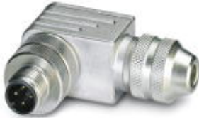
Sensor-/Aktor-Stecker, Stecker, gewinkelt, 4-polig, M12 geschirmt, A-kodiert, Schraubanschluss, Metallrändel, Kabelverschraubung Pg7
