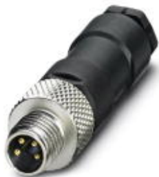
Sensor-/Aktor-Stecker, Stecker, gerade, 4-polig, M8, Lötanschluss, Metallrändel, Kabeldurchmesser max. 5 mm
