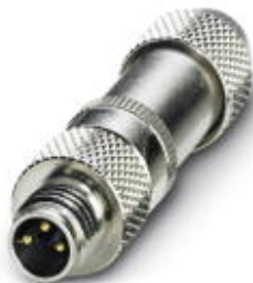
Sensor-/Aktor-Steckverbinder, Stecker, gerade, 3-polig, M8 geschirmt, Lötanschluss, Metallrändel, Kabeldurchmesser max. 5 mm
