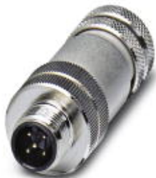
Sensor-/Aktor-Stecker, Stecker, gerade, 5-polig, M12 geschirmt, A-kodiert, Schraubanschluss, Metallrändel, Kabelverschraubung Pg9
