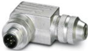
Sensor-/Aktor-Stecker, Stecker, gewinkelt, 5-polig, M12 geschirmt, A-kodiert, Schraubanschluss, Metallrändel, Kabelverschraubung Pg7
