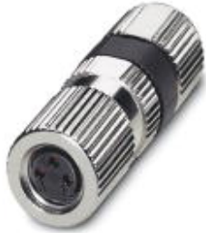
Sensor-/Aktor-Stecker, Buchse, gerade, 3-polig, M8, Piercecon ® , Metallrändel, Kabeldurchmesser max. 5 mm
