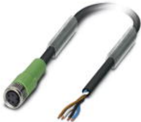
Sensor-/Aktor-Kabel, 4-polig, PUR halogenfrei, schwarzgrau RAL 7021, freies Leitungsende, auf Buchse gerade M8, Kabellänge: 1,5 m
