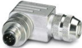
Sensor-/Aktor-Stecker, Stecker, gewinkelt, 5-polig, M12 geschirmt, A-kodiert, Schraubanschluss, Metallrändel, Kabelverschraubung Pg9
