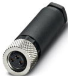
Steckverbinder, 3-polig, Buchse gerade M8, A-kodiert, Schraubanschluss, Rändelmaterial: Messing, vernickelt, Kabelaußendurchmesser 3,5 mm ... 5 mm
