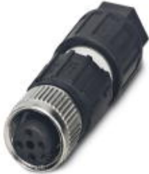
Sensor-/Aktor-Steckverbinder, 4-polig, Buchse gerade M12, A-kodiert, Schneidklemmanschluss, Rändelmaterial: Zinkdruckguss, vernickelt, Kabelaußendurchmesser 3,5 mm ... 6 mm
