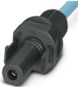
Photovoltaik-Steckverbinder, Nennstrom: 40 A, Nennspannung: 1500 V, Anschlussart: Crimp, Farbe: schwarz, Nur mit Werkzeug entriegelbar
