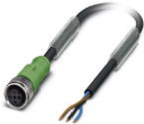
Sensor-/Aktor-Kabel, 3-polig, PUR halogenfrei, schwarzgrau RAL 7021, freies Leitungsende, auf Buchse gerade M12, A-kodiert, Kabellänge: 5 m
