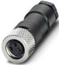
Sensor-/Aktor-Stecker, Buchse, gerade, 3-polig, M8, Lötanschluss, Metallrändel, Kabeldurchmesser max. 5 mm
