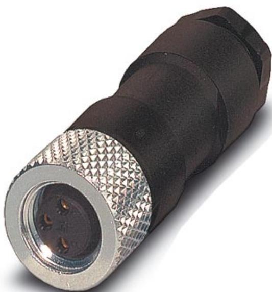
Sensor-/Aktor-Stecker, Buchse, gerade, 4-polig, M8, Lötanschluss, Metallrändel, Kabeldurchmesser max. 5 mm
