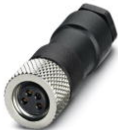
Sensor-/Aktor-Stecker, Buchse, gerade, 4-polig, M8, Lötanschluss, Metallrändel, Kabeldurchmesser max. 5 mm
