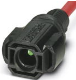
Photovoltaik-Steckverbinder, Nennstrom: 40 A, Nennspannung: 1500 V, Anschlussart: Crimp, Farbe: schwarz, Nur mit Werkzeug entriegelbar
