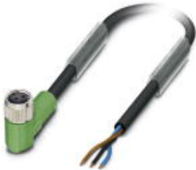
Sensor-/Aktor-Kabel, 3-polig, PUR halogenfrei, schwarzgrau RAL 7021, freies Leitungsende, auf Buchse gewinkelt M8, Kabellänge: 5 m
