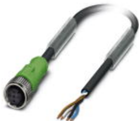
Sensor-/Aktor-Kabel, 4-polig, PUR halogenfrei, schwarzgrau RAL 7021, freies Leitungsende, auf Buchse gerade M12, A-kodiert, Kabellänge: 5 m
