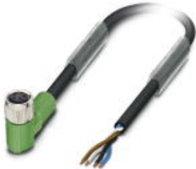
Sensor-/Aktor-Kabel, 4-polig, PUR halogenfrei, schwarzgrau RAL 7021, freies Leitungsende, auf Buchse gewinkelt M8, Kabellänge: 1,5 m
