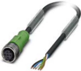
Sensor-/Aktor-Kabel, 5-polig, PUR halogenfrei, schwarzgrau RAL 7021, freies Leitungsende, auf Buchse gerade M12, A-kodiert, Kabellänge: 3 m
