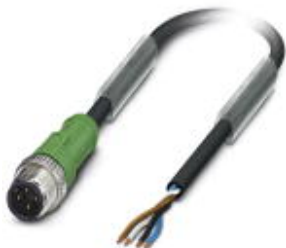
Sensor-/Aktor-Kabel, 4-polig, PUR halogenfrei, schwarzgrau RAL 7021, Stecker gerade M12, A-kodiert, auf freies Leitungsende, Kabellänge: 3 m
