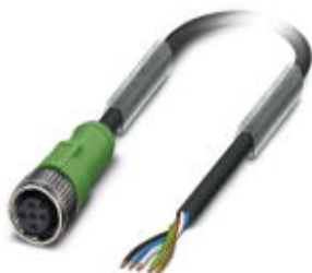
Sensor-/Aktor-Kabel, 5-polig, PUR halogenfrei, schwarzgrau RAL 7021, freies Leitungsende, auf Buchse gerade M12, A-kodiert, Kabellänge: 5 m
