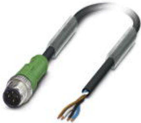
Sensor-/Aktor-Kabel, 4-polig, PUR halogenfrei, schwarzgrau RAL 7021, Stecker gerade M12, A-kodiert, auf freies Leitungsende, Kabellänge: 10 m
