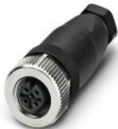
Sensor-/Aktor-Stecker, Buchse, gerade, 4-polig, M12, A-kodiert, Schraubanschluss, Metallrändel, Kabelverschraubung Pg7
