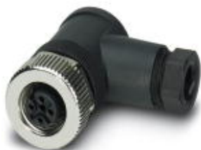
Sensor-/Aktor-Stecker, Buchse, gewinkelt, 4-polig, M12, A-kodiert, Schraubanschluss, Metallrändel, Kabelverschraubung Pg7
