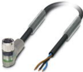
Sensor-/Aktor-Kabel, 3-polig, PUR halogenfrei, schwarzgrau RAL 7021, freies Leitungsende, auf Buchse gewinkelt M8, mit 2 LEDs, Kabellänge: 3 m
