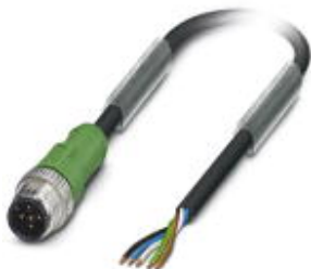
Sensor-/Aktor-Kabel, 5-polig, PUR halogenfrei, schwarzgrau RAL 7021, Stecker gerade M12, A-kodiert, auf freies Leitungsende, Kabellänge: 3 m
