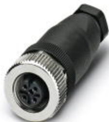
Sensor-/Aktor-Stecker, Buchse, gerade, 5-polig, M12, A-kodiert, Schraubanschluss, Metallrändel, Kabelverschraubung Pg7
