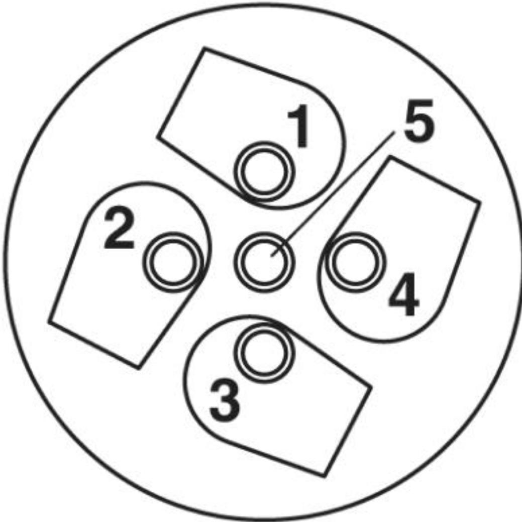
Kabelanschlussseite M12 (Schraubanschluss)
