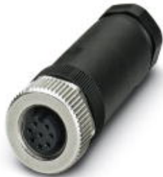
Sensor-/Aktor-Stecker, Buchse, gerade, 8-polig, M12, A-kodiert, Schraubanschluss, Metallrändel, Kabelverschraubung Pg9
